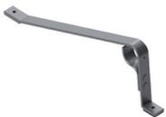
Der Schneefänger mit einem Loch wird mit einem unteren EPDM-Dichtungsgummi geliefert. Zur Verankerung eines Schneefängers sind 2 Stück Schrauben 4,8 x 80 mm erforderlich, die idealerweise durch die Dachlatte in den Dachsparren geschraubt werden.
