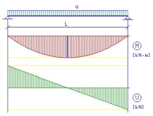
Bild 1.1: Verlauf der Biegemomente  $M_{Sd}$  und der Querkräfte  $V_{Sd}$  des Trägers mit einem Feld
