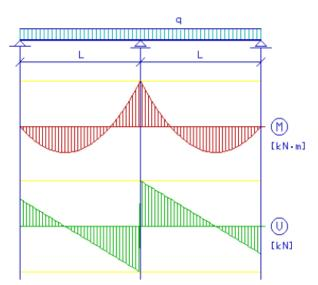
Bild 1.2: Verlauf der Biegemomente  $M_{Sd}$  und der Querkräfte  $V_{Sd}$  des Trägers mit zwei Feldern
