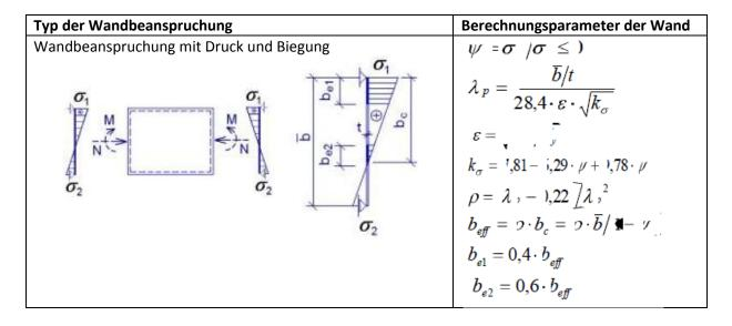
Tab. 2: Lösung der Wandstabilität für überragende geschobene Querschnittteile
