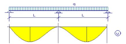
Bild 1.5: Umschlag des Trägers mit zwei Feldern  $\delta$
