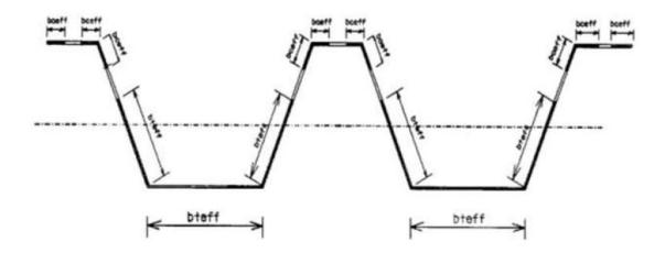
Bild 1.13: Kennzeichnung der effektiven Breiten in den Querschnittwänden
