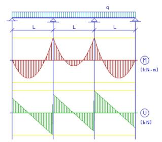
Bild 1.3: Verlauf der Biegemomente M<sub>Sd</sub> und der Querkräfte V<sub>Sd</sub> des Trägers mit drei Feldern
