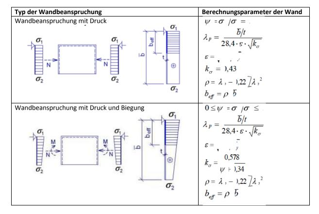
Die effektive Breite geschobener Wände ist vom Verlauf der Normalspannungen in der Wand abhängig.
