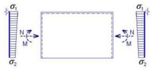
Bild 1.12: Wandbeanspruchung mit Kombination von Druck und Biegung
