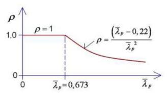
Bild 1.7: Verlauf des Reduktionskoeffizienten ρ
