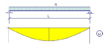
Bild 1.4: Umschlag des Trägers mit einem Feld  $\delta$
