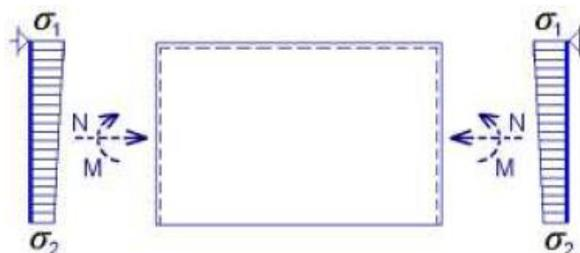
**Bild 1.12: Wandbeanspruchung mit Kombination von Druck und Biegung**
