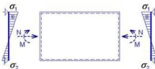
**Bild 1.10: Wandbeanspruchung mit Kombination von Druck und Biegung**
