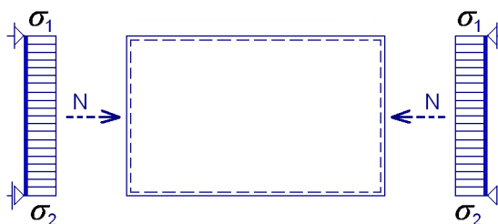
Abb. 1.8: Belastung der Wand durch Druck
