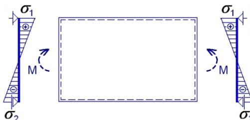
Abb. 1.9: Wandbiegespannung
